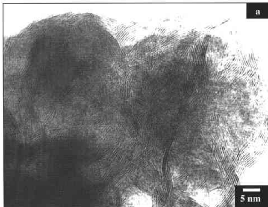
Figura 32. Micrografías de MET de los catalizadores activados por el método in situ , a) Ni/H-WS 2 in situ , b) Ni/C 3 -WS 2 in situ .
