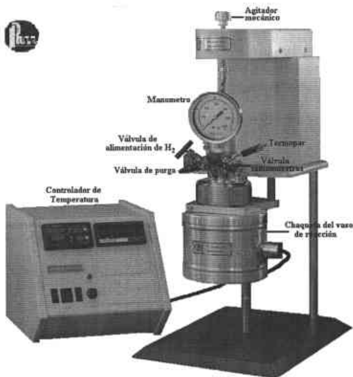
Figura 12. Reactor batch usado en la HDS del DBT en el laboratorio.
