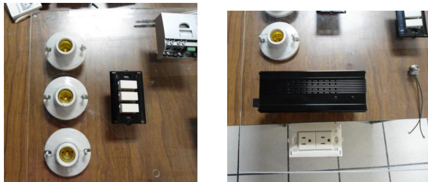
Figura 27 Apagadores y contactos para cargas de CA.
