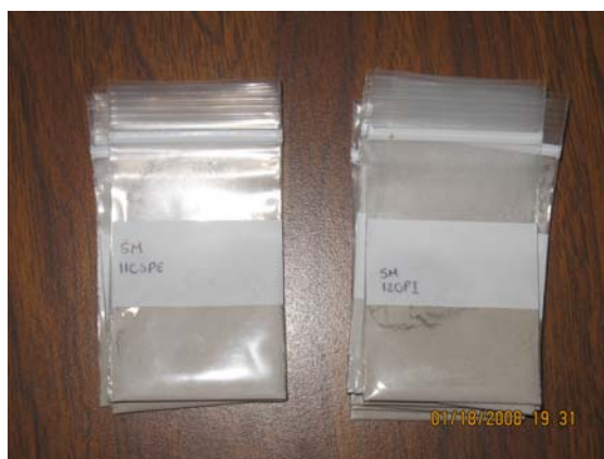
Figura 3.11. Muestras del polvo extraído de la interfase acero-concreto
