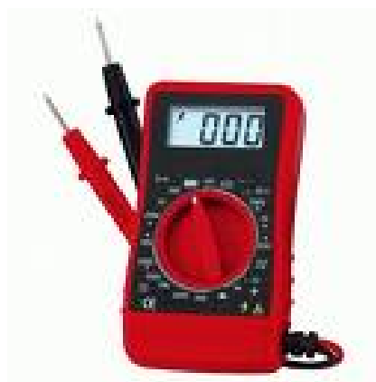
Figura 3.6 Multímetro de alta impedancia para medición de potenciales
