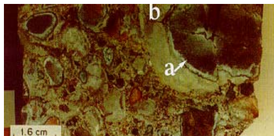
Figura 1.2. Gel provocado por la reacción álcali-sílice como se señala en el punto a
