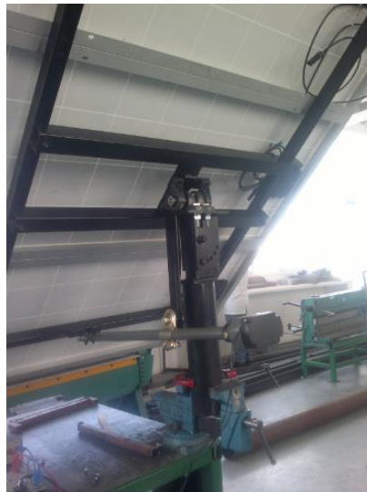
Figura 3.27.- Sujeción de los módulos y del actuador.
