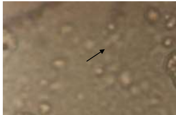
Figura 31.- Suspensión de montmorillonita tratada con \text{Na}_2\text{CO}_3 . No se observa mejora en la dispersión respecto a la dispersión original sin tratamiento (fotografía 1).
