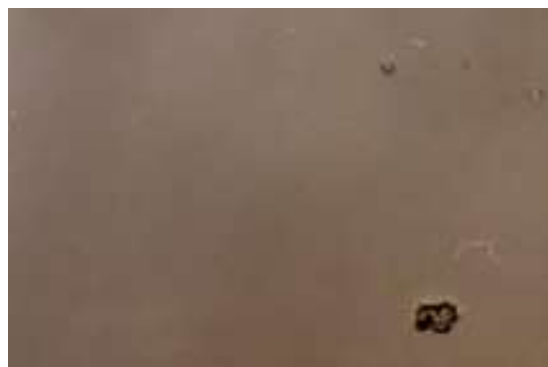
Figura 47.- Suspensión de a-200 tratado con 60 min. a ultrasonido. El pH de la suspensión 6.47, los aglomerados han desaparecido por completo, al menos a este número de aumentos.
