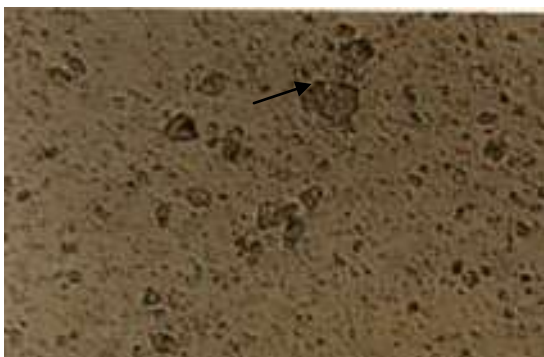
Figura 35.- Suspensión de arcilla BMODI24 tratada con 20 min. de ultrasonido. El método de preparación para la observación es el mismo en todos los casos. Se mejoró el estado de dispersión de las partículas observándose aglomerados más pequeños.
