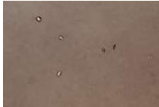
Figura 48.- Suspensión de a-200 tratado con 80 min. de ultrasonido. El pH de la suspensión 6.47, reaparecen los aglomerados como se aprecia en a).
