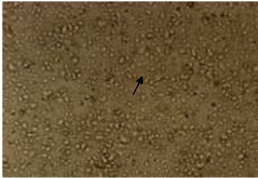
Figura 33.- Suspensión de montmorillonita tratada con Hexametáfosfato de sodio ( \text{Na}_8\text{P}_6\text{O}_{19} ). Se puede observar una mejor dispersión de las partículas con formación de aglomerados de solo unas cuantas partículas.
