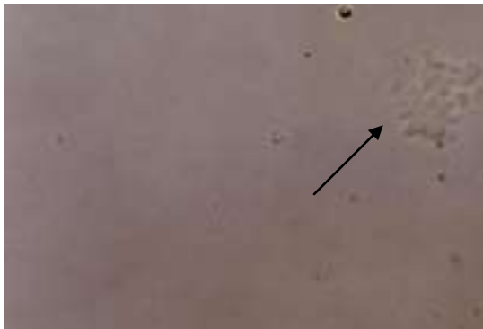
Figura 46.- suspensión de a-200 tratada con 40 min. a ultrasonido. El pH de la suspensión 6.47, se observa una disminución marcada en los aglomerados de la suspensión.
