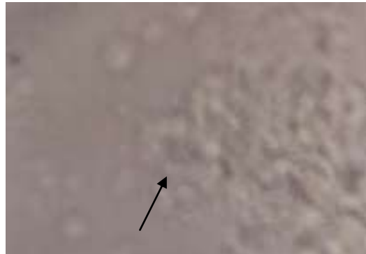
Figura 42.- Suspensión de A-200 sin tratamiento, pH de la suspensión 6.47. Se observan aglomerados grandes en la suspensión.
