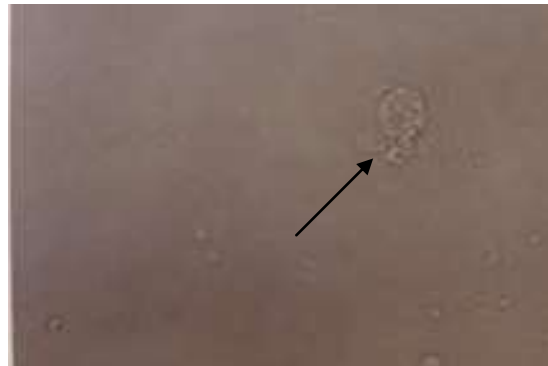
Figura 46.- suspensión de a-200 tratada con 40 min. a ultrasonido. El pH de la suspensión 6.47, se observa una disminución marcada en los aglomerados de la suspensión.
