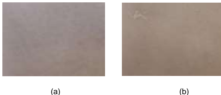
Figura 14.- Fotografía de A-200 pirogénico tratado para aumentar grupos hidroxilo superficiales, después de ser sometido a 40 min. de ultrasonido. (a) Fotografía tomada a 20x, (b) fotografía tomada a 100x.
