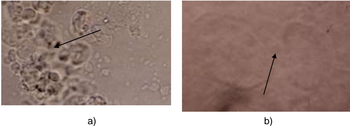
Figura 11.- Suspensión de A-200 Pirogénico sin tratamiento, pH de la suspensión 6.47. Se observan aglomerados grandes en la suspensión como lo indican las flechas. a) foto tomada a 20x de amplificación, b) foto tomada a 200x de amplificación.
