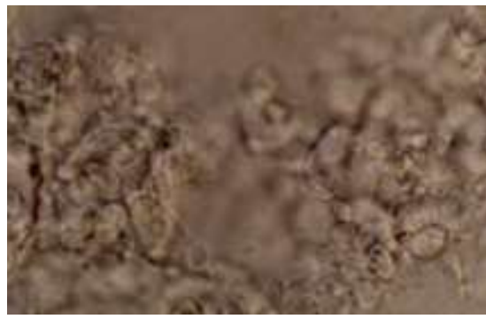
Figura 50.- Suspensión de A-200 tratado con \text{Na}_2\text{CO}_3 . No se observa mejora en la dispersión respecto a la dispersión original sin tratamiento (fotografía 18), e incluso se observa formación de flóculos más grandes.
