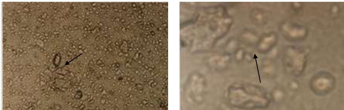
Figura 26.- Suspensión de montmorillonita tratada con 20 min. de ultrasonido. El método de preparación para la observación es el mismo en todos los casos.
