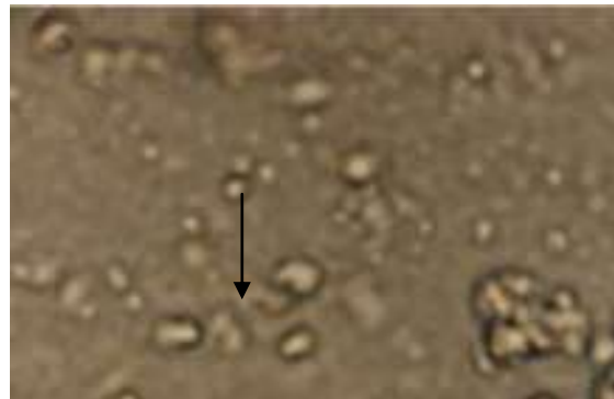
Figura 34.- a) Suspensión de arcilla BMODI24 sin tratamiento pH=10.5, donde se pueden apreciar aglomerados de partículas como se indica en las flechas, fotografías tomadas a 20x. b) Ampliación de la fotografía a) tomada a 100x, se puede observar mejor la formación de aglomerados entre partículas.
