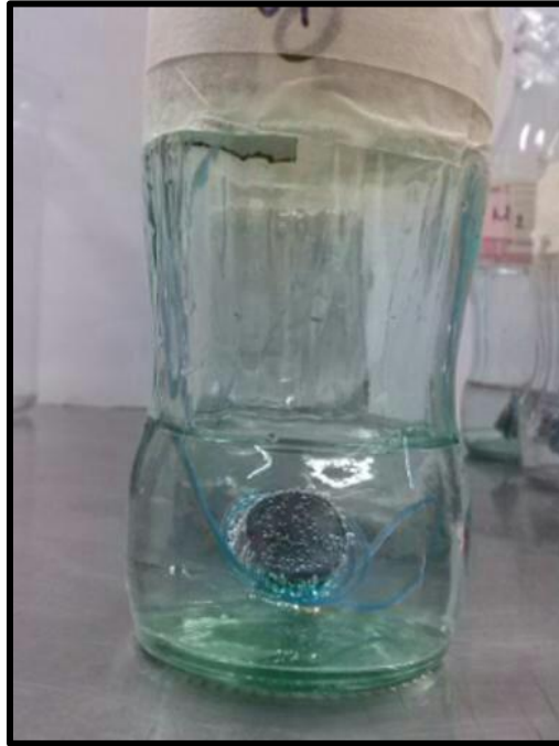
Figura 15. Celda de experimentación para pruebas gravimétricas.
