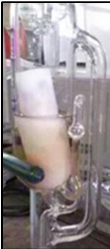
Figura 11. Color de la materia prima en contacto con una mezcla de metanol y acetona al 50% en volumen.
