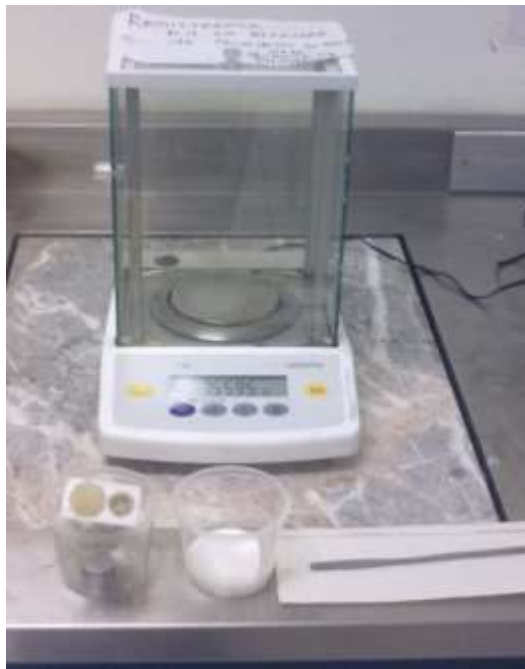
Figura 30. Adición del inhibidor de aire a la resina.
