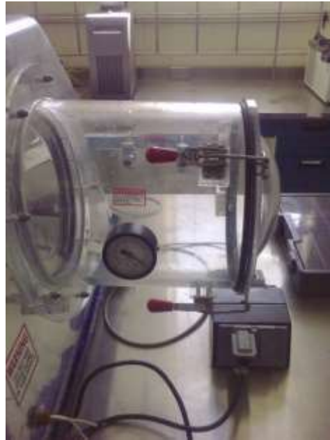
Figura 34. Cámara de vacío.
