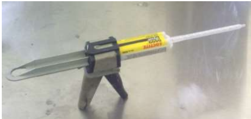
Figura 32. Colocación del cartucho de adhesivo en la pistola
