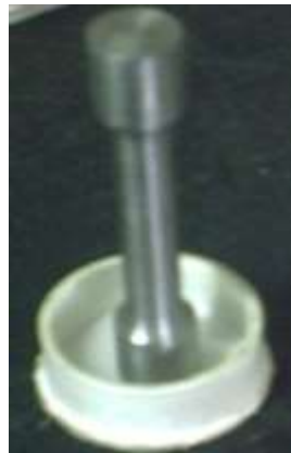
Figura 23. Adherencia del estándar al tapón de PVC.
