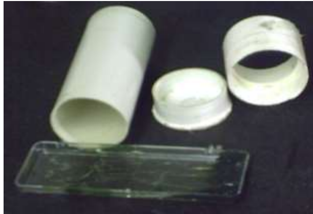
Figura 22. Engrasado de las piezas que conforman el recipiente.
