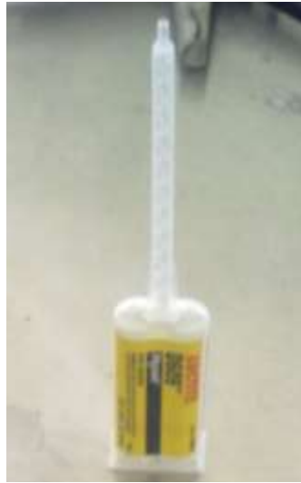
Figura 31. Ensamblaje del mezclador al cartucho de adhesivo.
