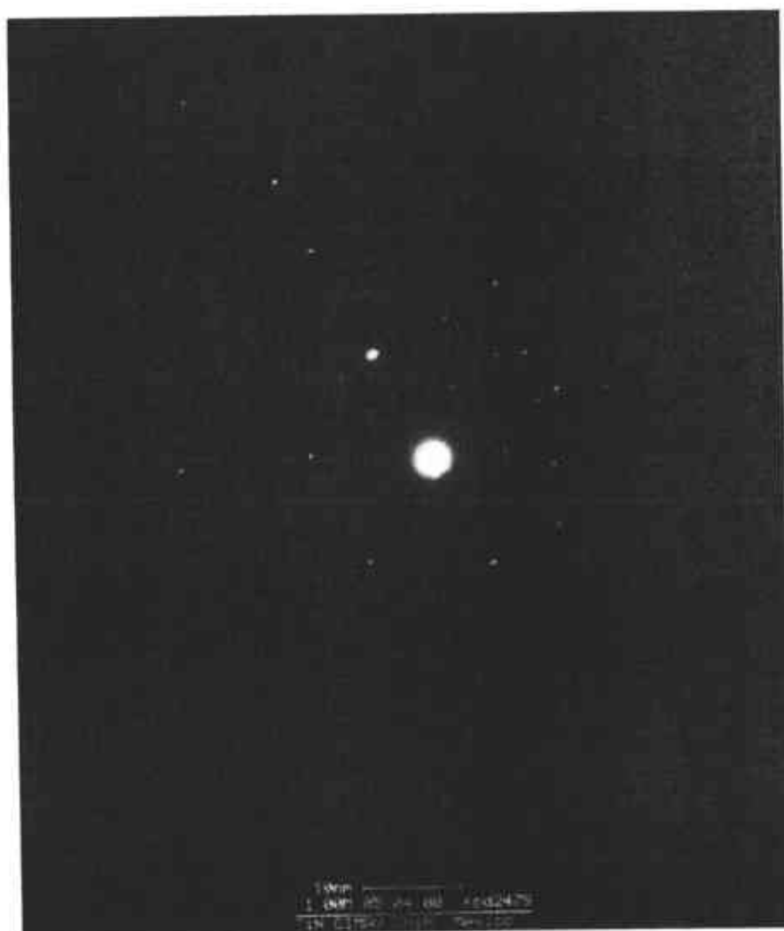
Figura 3.- Patrón de difracción de Electrones de TiN.
