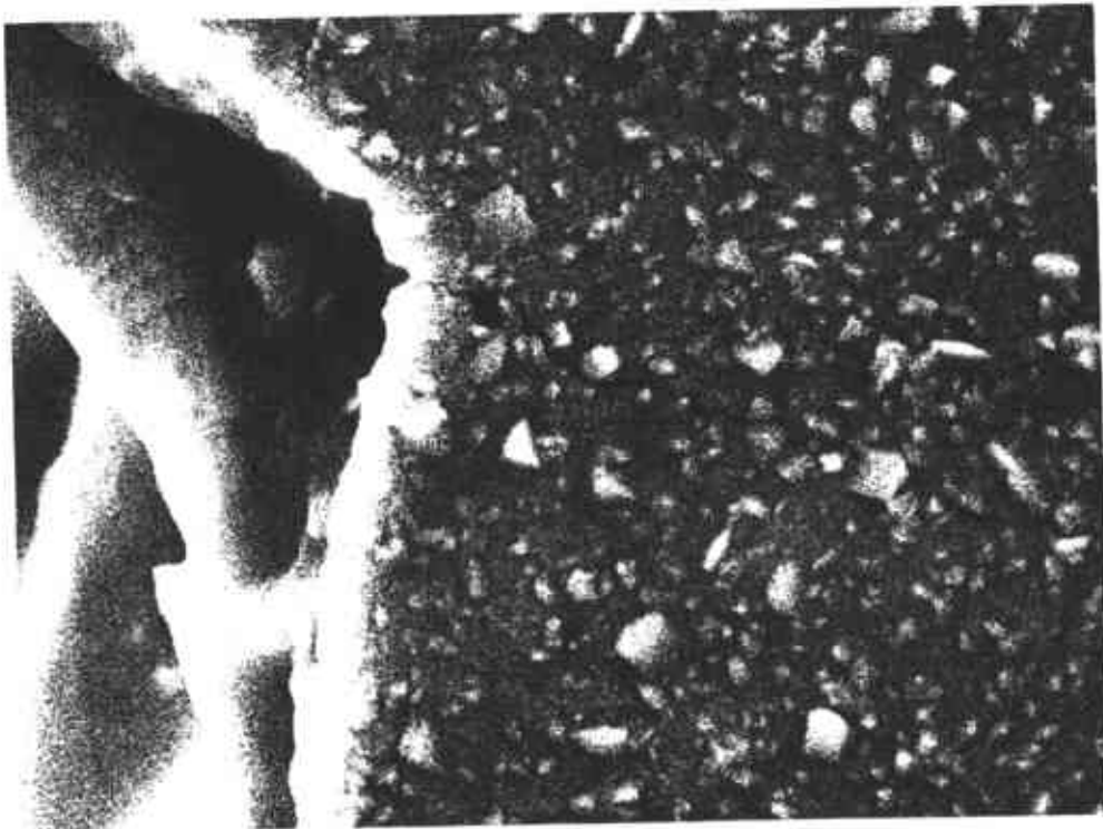
Figura 1.- Micrografía SEM de la superficie de TiN amplificada a 10000x a 15 kV.
