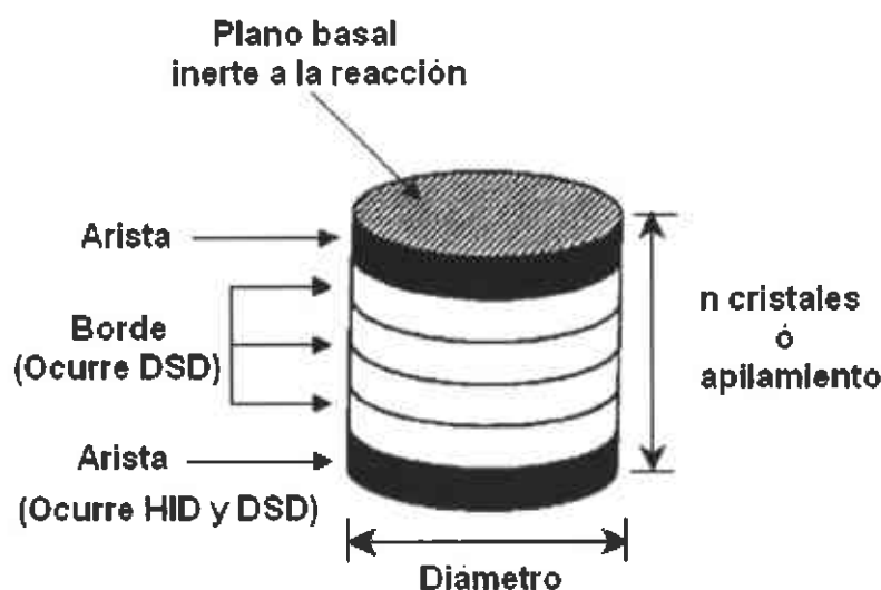
Figura 11. Modelo "arista-borde" para sulfuros de metales de transición no promovidos (Tomado de Daage y Chianelli, 1994)
