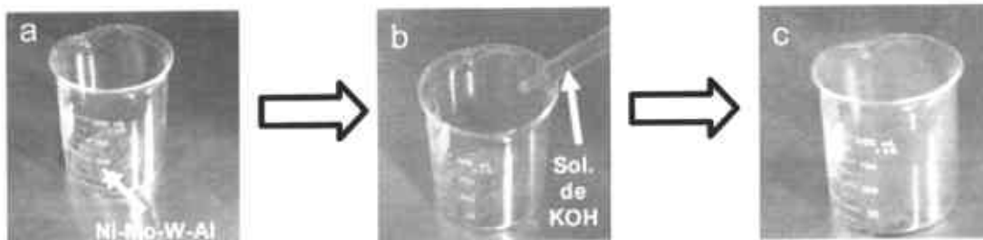
Figura 27. Lixiviación a temperatura ambiente (en frío): a) Antes de lixiviación, b) Adición de solución de KOH, y c) Lixiviación de aleación de Ni-Mo-W-Al durante 1 hora.
