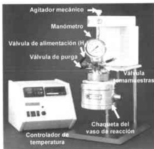
Figura 36. Reactor batch usado en laboratorio para la HDS del DBT
