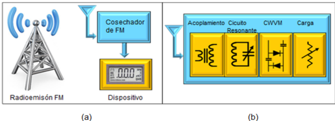
Figura 23. Sistema de cosechamiento de energía: (a) Concepto del proceso de captura energética y (b) Descripción general de las etapas del sistema.
