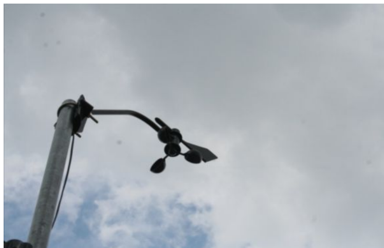
Fig. 2.19.- Anemómetro que forma parte de la estación meteorológica de la UTZMG
