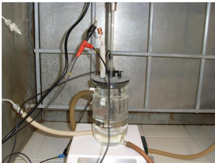
**Figura 3.1** Arreglo experimental utilizado en las técnicas electroquímicas.
