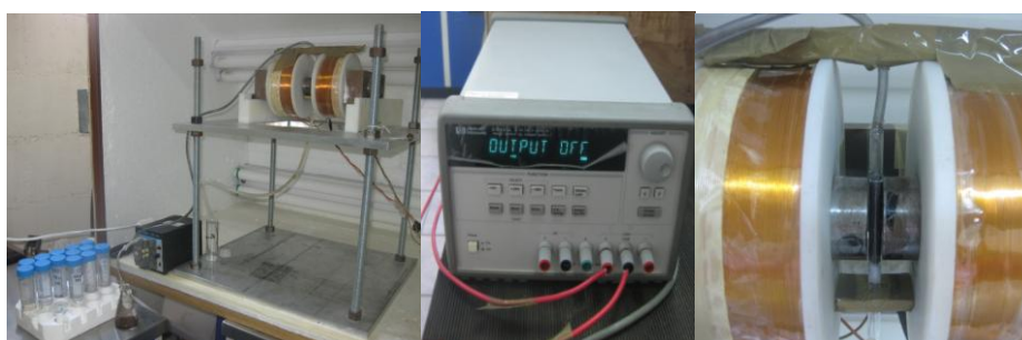
Figura 15. Electroimán, fuente de corriente y columna de filtración
