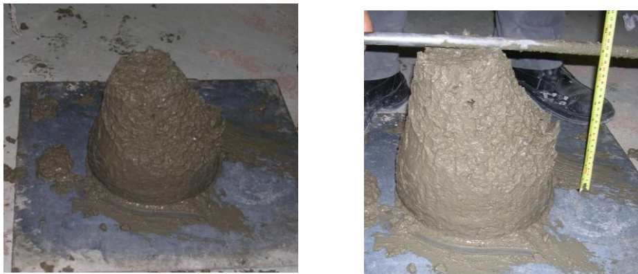
Figura 11. Buena trabajabilidad en la prueba del revenimiento.®
