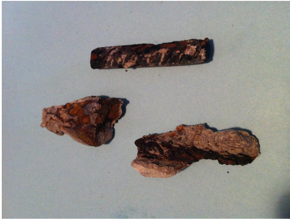
Figura 26. Elemento de acero de refuerzo con corrosión inicial proveniente de una probeta de concreto simple (SC).
