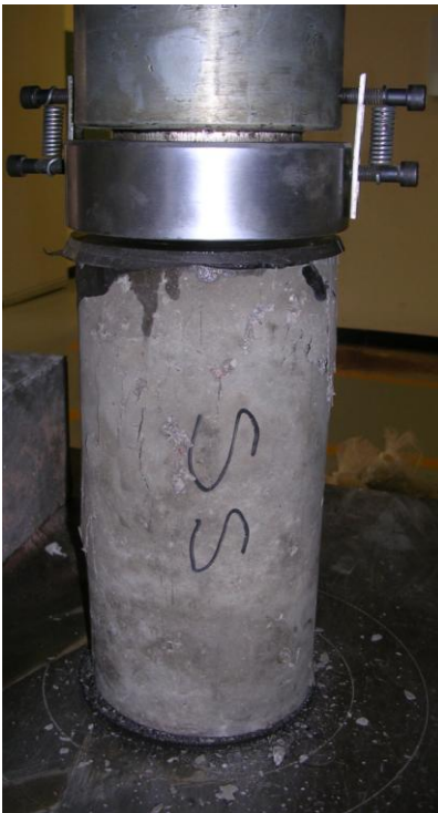
Figura 15. Probeta de concreto sin micro sílice siendo sometida a prueba de compresión en la prensa universal.
