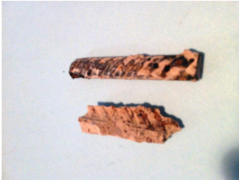
Figura 23. Muestra de concreto con microsilíce con Acero de refuerzo sin corrosión inicial (CS).
