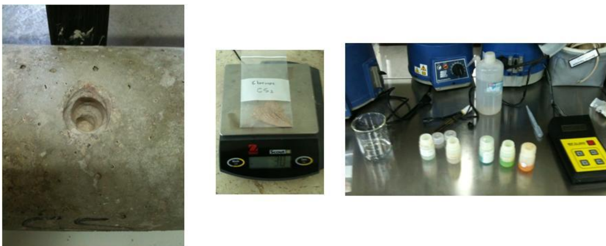
Figura 18. Probeta de concreto después hacer las perforaciones y recolección de polvo del concreto para elaborar las pruebas para la determinación de cloruros.®
