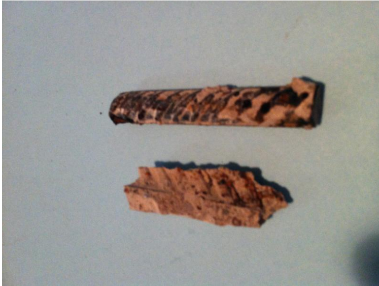
Figura 24. Elemento de refuerzo proveniente de una probeta de concreto con adición de microsílíce. (CC).
