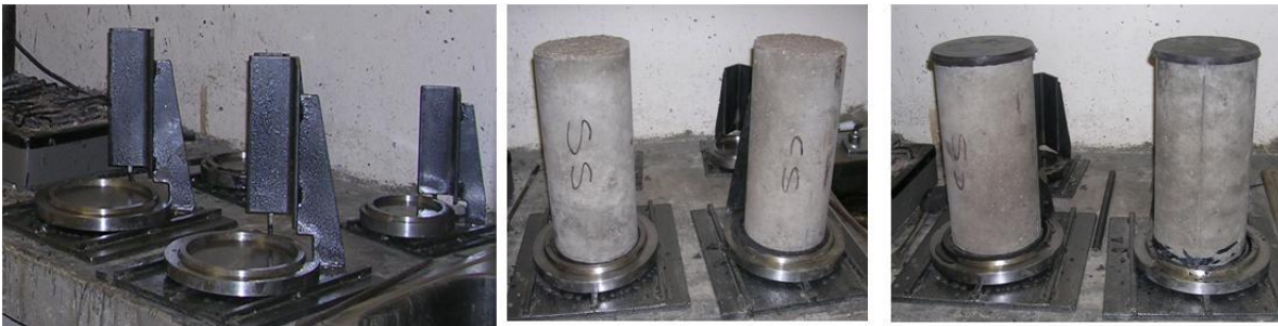
Figura 14. Especímenes cabeceados para ensayos de compresión.
