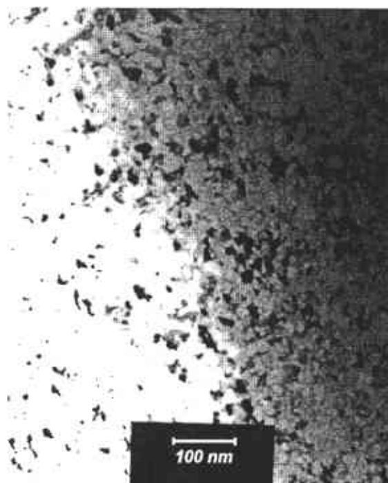
Figura III-47. Imagen de la muestra calentada durante a 673 K, 60 min, en una escala de 100 nm.
