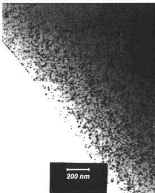
Figura III-41. Imagen del Metglas calentado a 673 K, durante 5 min.
