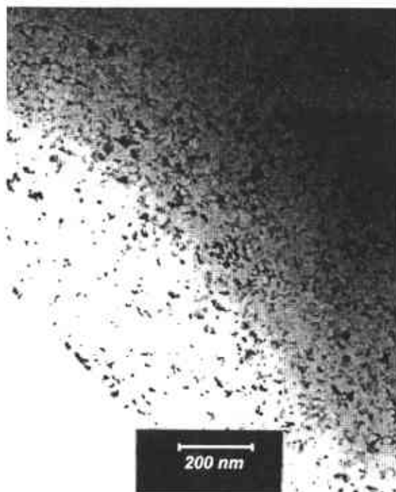
Figura III-46. Imagen de la muestra calentada a 673 K, durante 60 min, en una escala de 200 nm.
