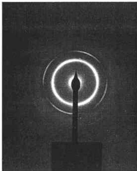
Figura III-40. Patrón de difracción de la muestra calentada a 673 K ,durante 3 min.
