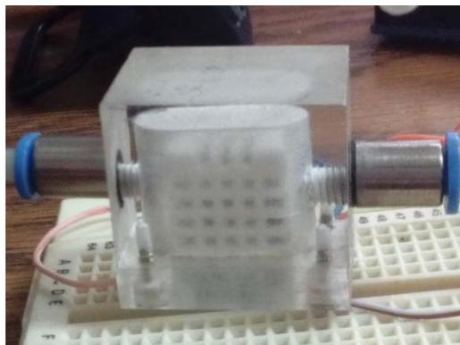
**Figura 49. Sensor de humedad AOSONG AM2302 ensamblado en la caja de acrílico**
