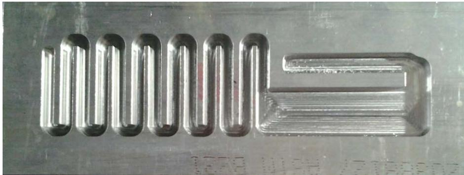
**Figura 45. Placa del maquinado del prototipo del humidificador ya terminado**
