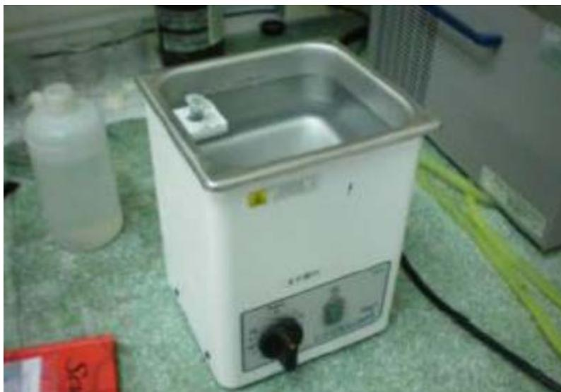
Figura 35. Solución sometida a un baño sónico para que la mezcla sea lo más homogénea posible.
