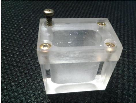
**Figura 49. Caja de acrílico para sensor de humedad AOSONG AM2302**
