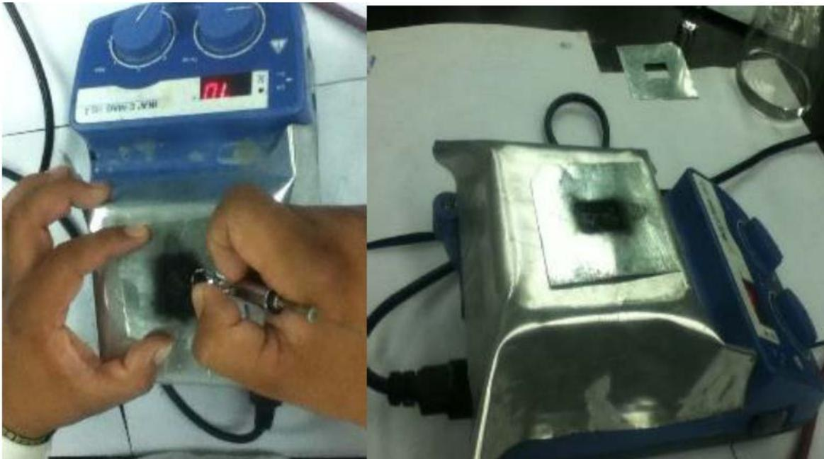
**Figura 33. Impregnación de la tinta catalítica en la tela de carbón.**
