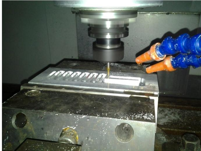
**Figura 44. Maquinado de la placa del prototipo del humidificador.**
