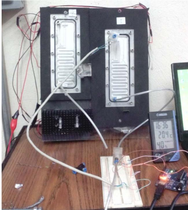
**Figura 51. Prototipo del humidificador con todos sus componentes.**
