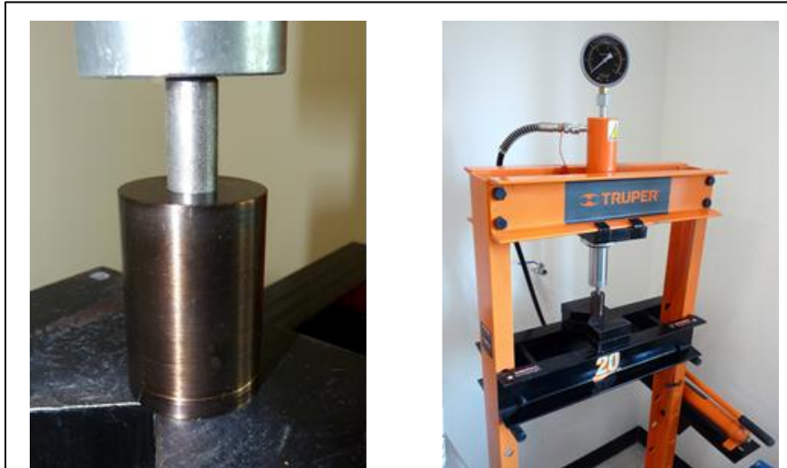
Figura 2.2. Imágenes del dado y la prensa utilizados en el prensado en caliente.
