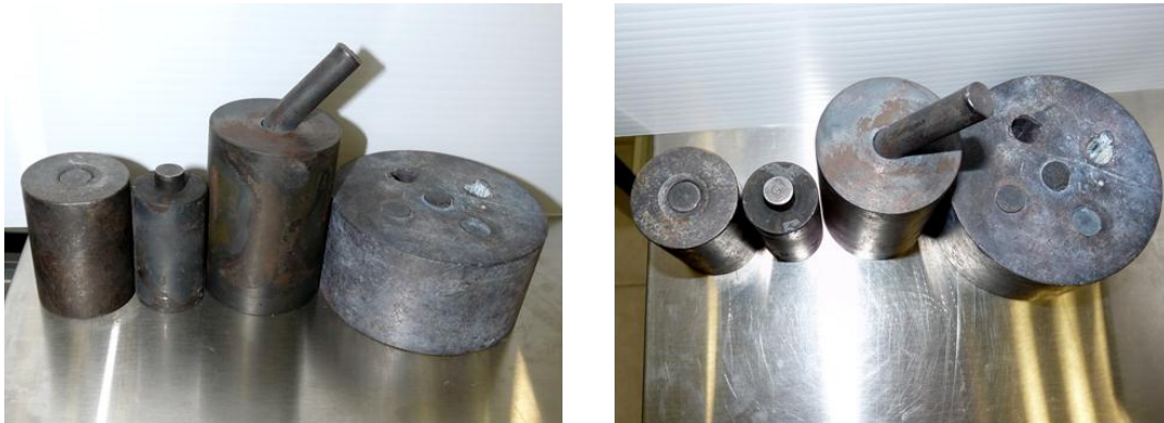
Figura 3.10. Dados y pistones utilizados para el proceso de prensado en caliente a 15 toneladas y 700°C.
