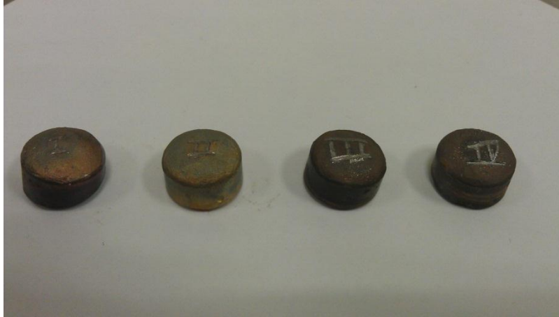
Figura 3.12. Cuatro de las probetas obtenidas mediante la técnica de fisión en orden izquierda a derecha en incremento del contenido de níquel.
