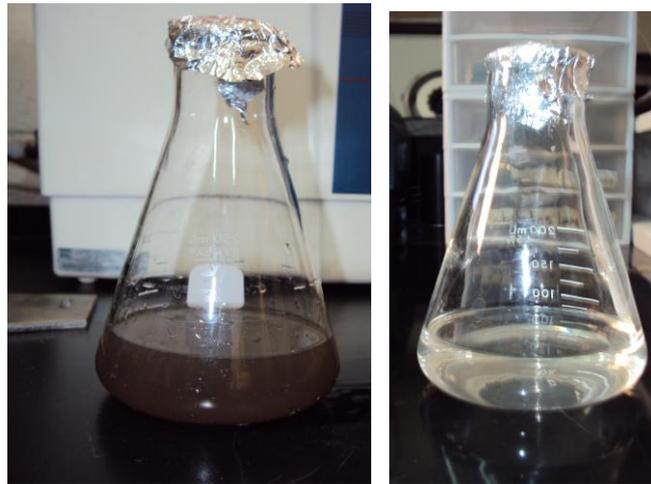
Figura 9. Agua antes y después de someterse a campo magnético.
