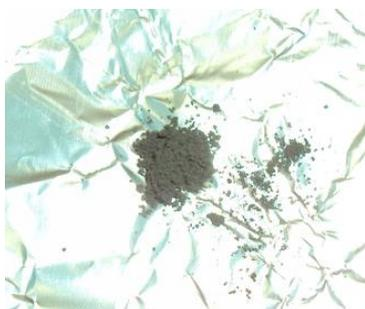
Figura 10. Muestra la magnetita en forma de polvo después de la síntesis.
