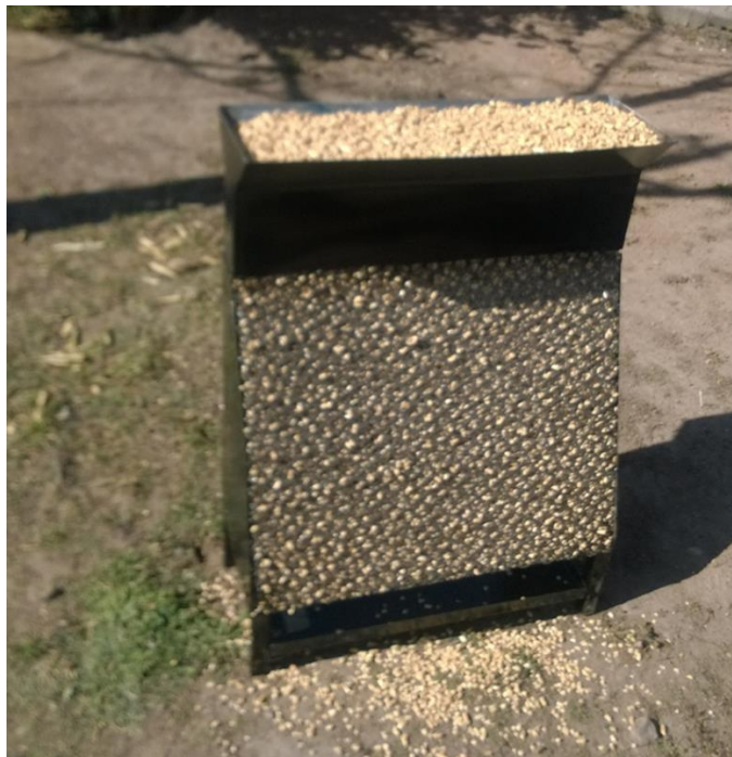
Figura 22 Prototipo de calentón usando pellets de aserrín como combustible
