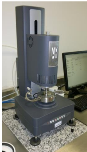
Figura 6.3.- Reómetro ARG2 en proceso de medición con control de temperatura mediante chaqueta termostatzada.
