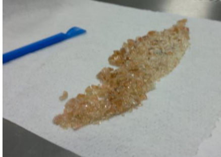
Figura 6.8.- Perlas reducidas de tamaño por medio de molienda.
