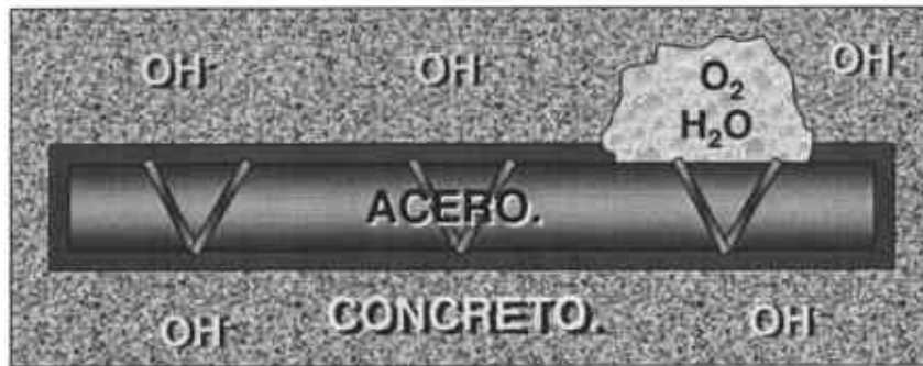
Figura 1.1. Acero pasivado en concreto, esta película de óxido protector se rompe en presencia de agentes agresivos como el oxígeno y humedad.
