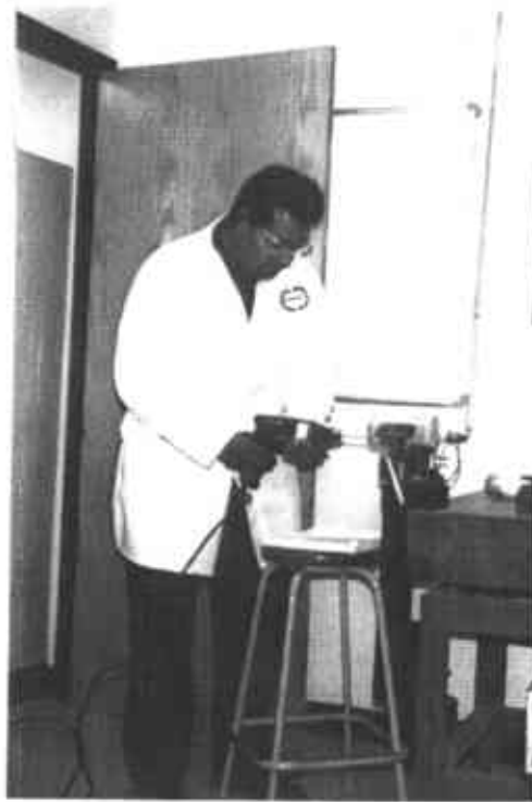
Figura 3.8. Extracción del polvo para la determinación de cloruros.
