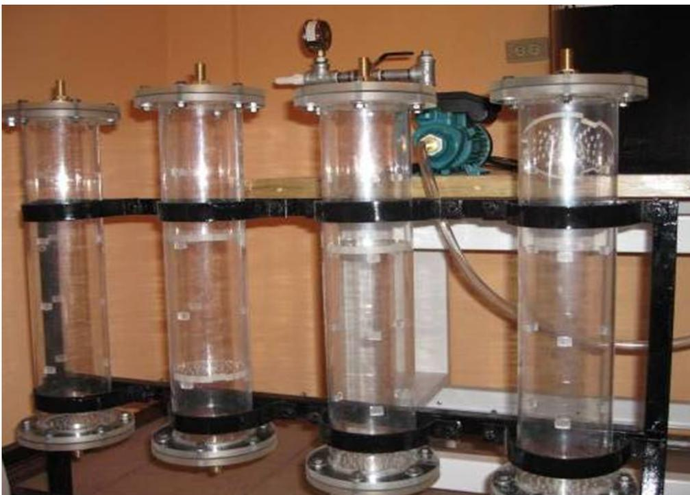
**Fig. 22 Banco de filtros para su operación en serie o en paralelo.**
