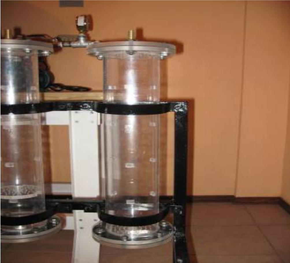
**Fig. 20 Filtro diseñado para el proceso de biosorción de los iones As, F, Cu, Cr, Pb y Zn, utilizando la cáscara de naranja como bioadsorbente.**
