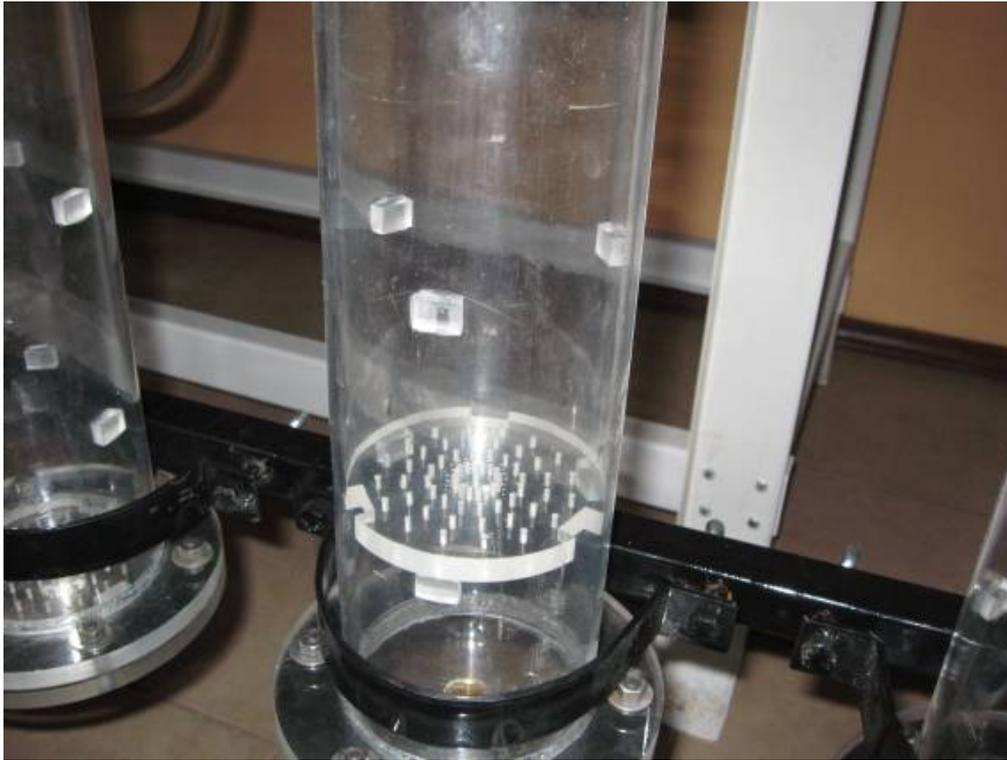
**Fig. 21 Detalle de la malla separadora empleada para soportar el material adsorbente.**
