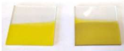
Fig. 4. 9 Películas de CdS con NP de Ag y Nitrato de plata
