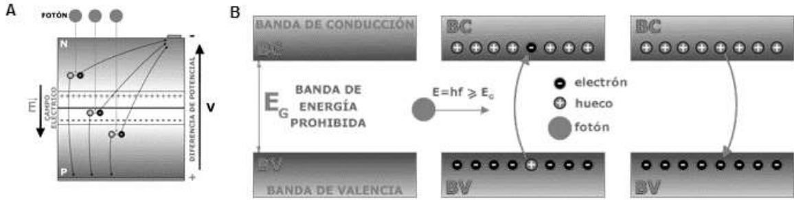
Fig. 2. 2 A: esquema del funcionamiento de una celda solar al incidir fotones en su superficie, B: movimiento de electrones en bandas de valencia y conducción
