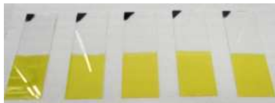
Fig. 4. 7 Películas de CdS después de tres baños consecutivos
