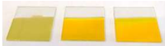
Fig. 4. 8 Películas de CdS depositadas sobre vidrio recubierto con ITO con 1, 2 y 3 baños
