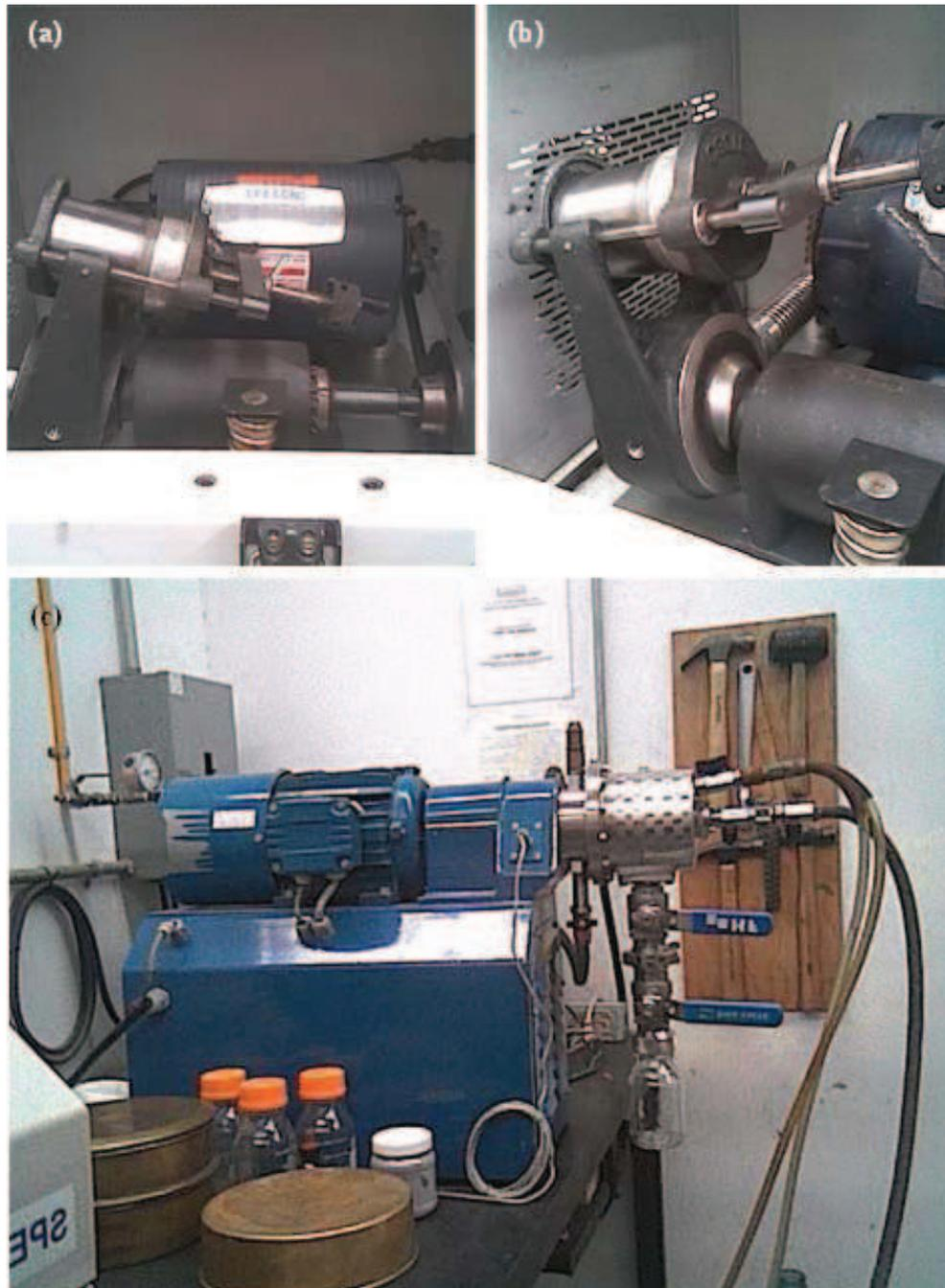
Figura 1.8 El aleado y la molienda se consigue mezclando polvos muy finos de diferentes metales. (a-b) Molino Simoloyer. (c) Molino Spex.
