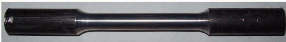
**Figura 2.10. Probeta de tensión maquinada según la norma ASTM B557M para aluminio y magnesio. Longitud de prueba de 30 mm y diámetro de 6 mm**
