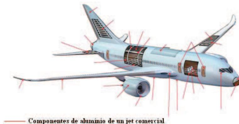
**Figura 1.4 Aplicaciones del aluminio en la industria aeronáutica. Se observa su uso en componentes estructurales y fuselaje las cuales son señaladas mediante líneas rojas.**
