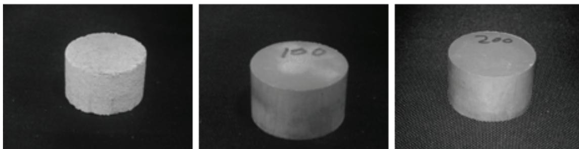
**Figura 2.6.** "Tochos" producidos de la compactación de los compósitos aluminio-nanotubos de carbono. Se presentan composiciones de 0.00%, 1.00% y 2.00% de los compósitos producidos con NTC usando SP.
