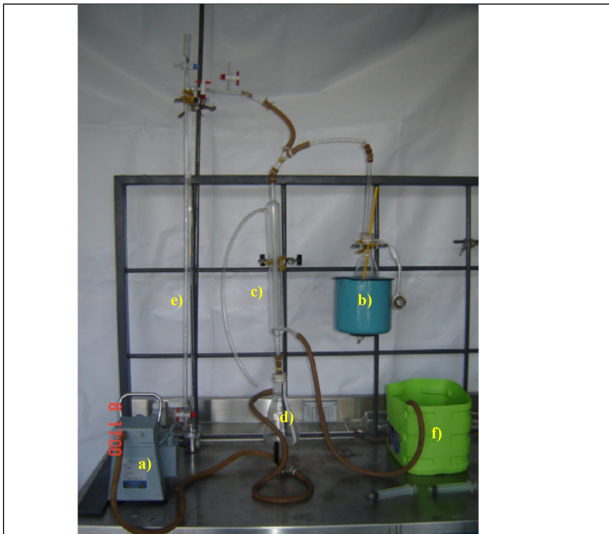
Figura 5.1.1 Arreglo para la experimentación en laboratorio. a) Bomba de vacío, b) Recipiente para mantener la temperatura de la muestra contenida en el matraz Erlenmeyer, c) Refrigerante, d) matraz Kitazato, e) Columna de mercurio para medir el vacío en comparación con un barómetro de mercurio, f) depósito de agua de enfriamiento
