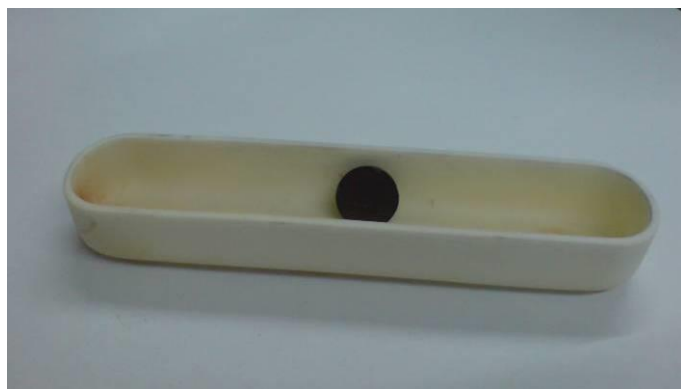
Figura 3.5. Para el tratamiento final de oxigenación, se utilizaron crisoles de alta alúmina en forma de canoa. La pastilla a sinterizar se coloca de canto con la finalidad de reducir al mínimo el contacto con el crisol.
