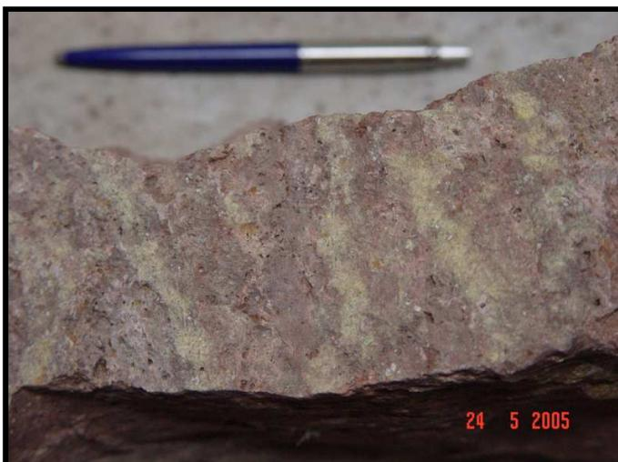
**Figura 12** Fotografía de roca uranífera extraída del afloramiento de San Marcos al noroeste de la ciudad de Chihuahua. La roca presenta unas bandas rellenas de polvo amarillo sobre la roca.
