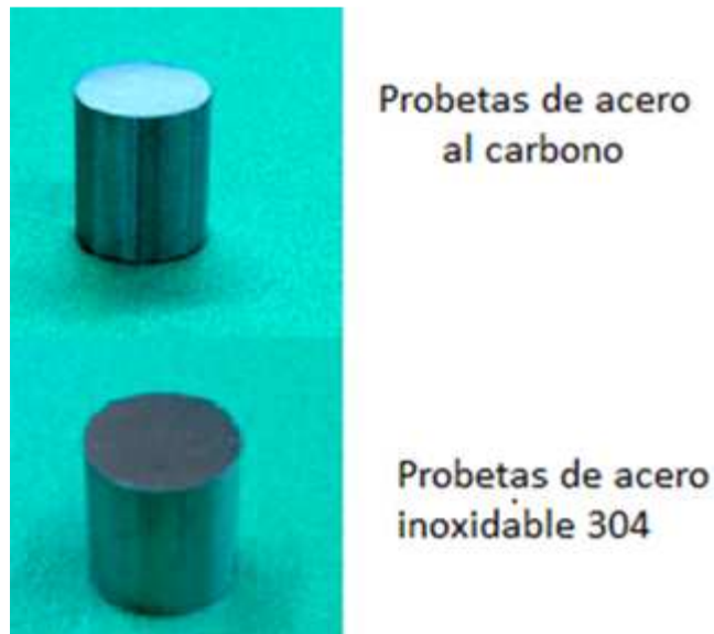
Fig 6. Muestra las probetas utilizadas para las pruebas de ruido electroquímico en el estudio.
