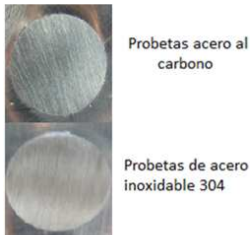
Fig 10. Muestra las probetas utilizadas para las pruebas de resistencia a la polarización lineal en el estudio.
