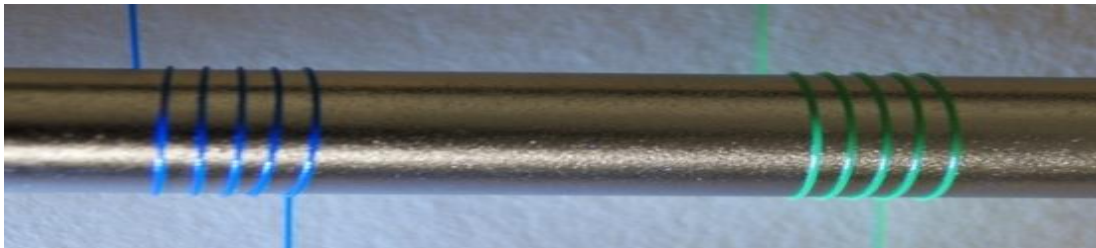
Figura 10. Fibras ópticas enrolladas alrededor de cilindros de acero.
