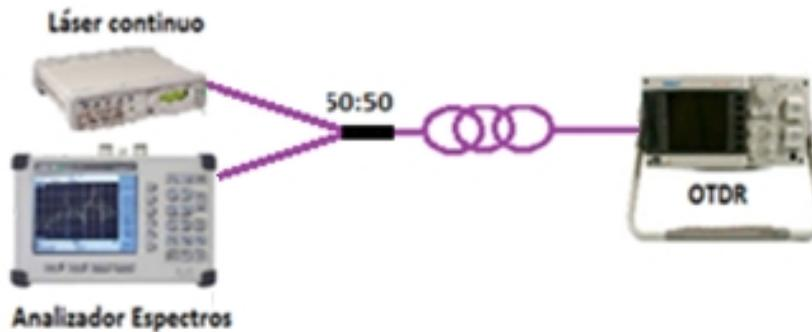
Fig IV 9. Gráfico de la conexión de la interacción del láser pulsado y continuo (TRCP).
