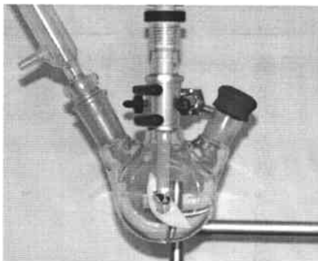
Figura 7.3 Reactor empleado para la realización de las polimerizaciones en emulsión y en miniemulsión
