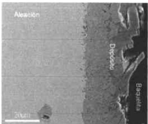
(b). Aleación Inconel 718 en ceniza natural a 806°C, amplificación de 1500x.
