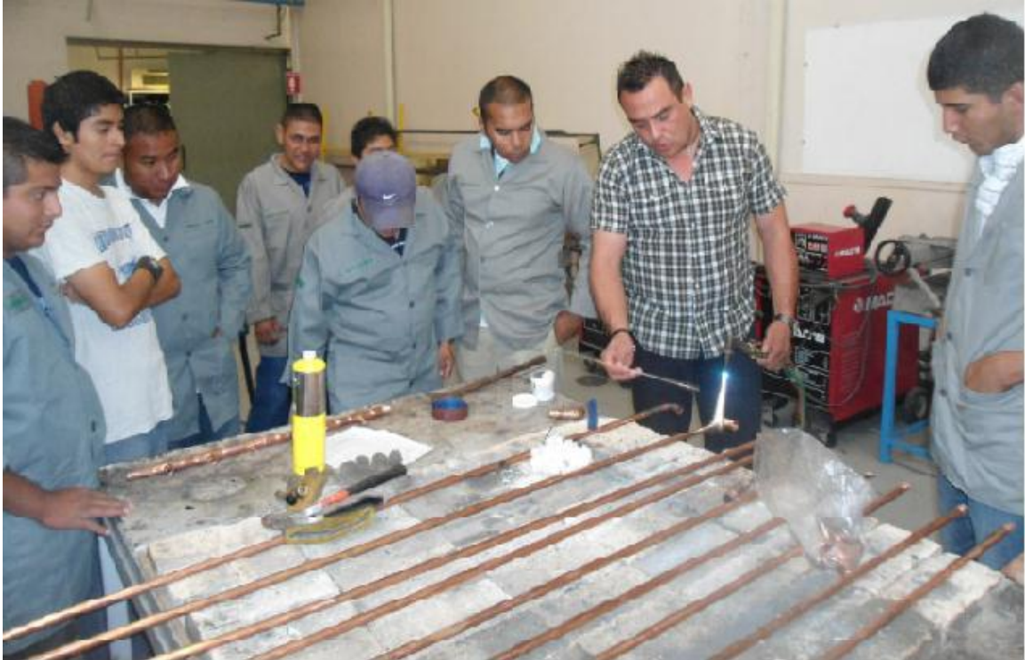
Un Ingeniero de la UTCJ les muestra a un grupo de alumnos, como se debe soldar con plata
