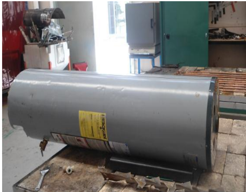
Imagen del recipiente que se usara como almacén de agua caliente
