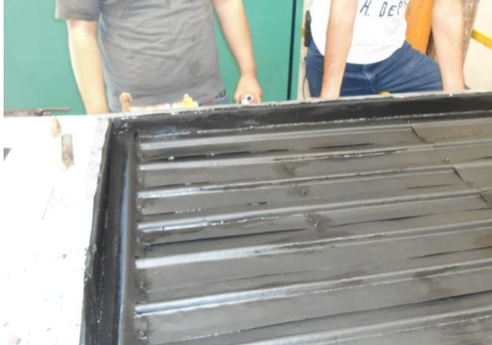
Pintando el colector ya terminado
