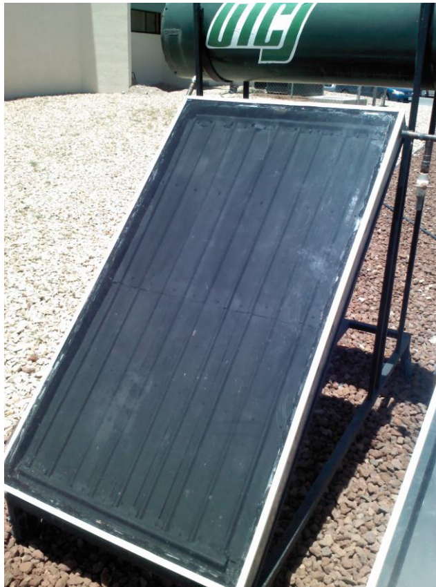
Colector solar de placa plana mejorado con un área de captación de 1.51 m 2
