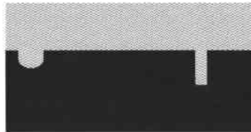
Esquema 2. Corrosión por picadura.
