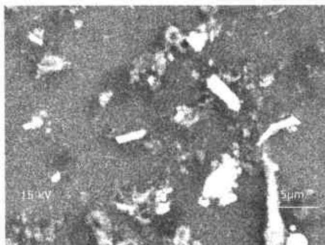
Fotografía 10. Micrografía del acero 17-7PH sin evidencia de corrosión, mostrando presencia de materia orgánica. 1000X
