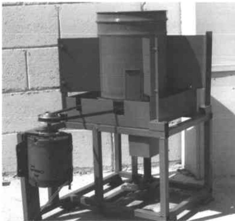
Figura 4. Aparato empleado para la esferonización de las partículas de poliéster + perlita y de perlita vitrificada.
