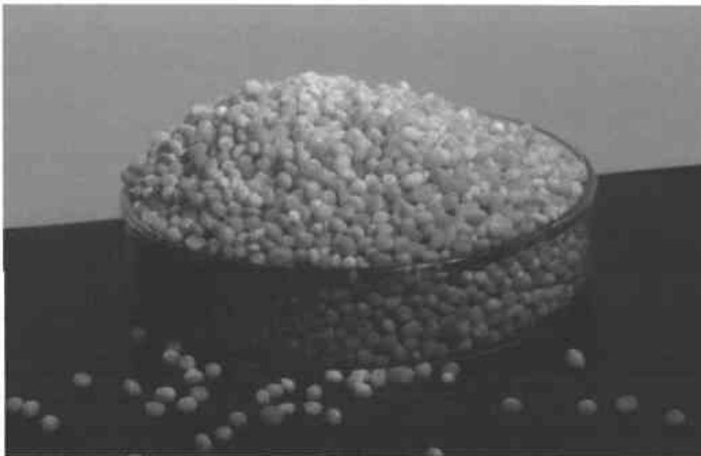
Figura 3. Partículas esferonizadas de la mezcla de poliéster+perlita.
