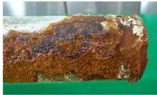
Figura 3.2. Tubo de acero y ánodo de Mg después de una semana de exposición al agua de enfriamiento en condiciones estáticas.
