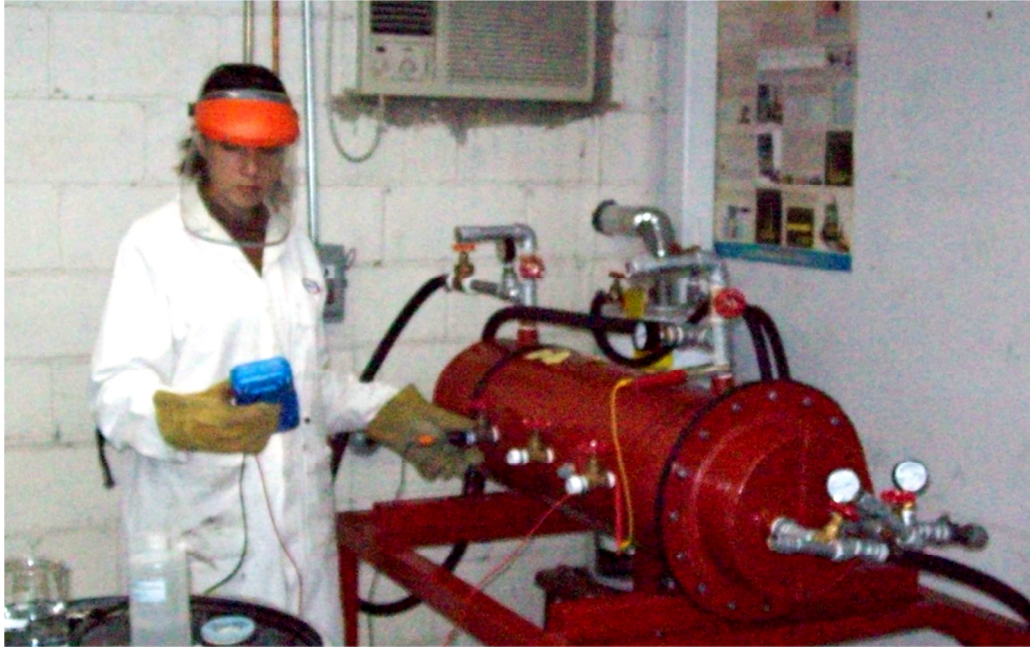
Fig. 2.17. Monitoreo de los potenciales de corrosión en el prototipo.
