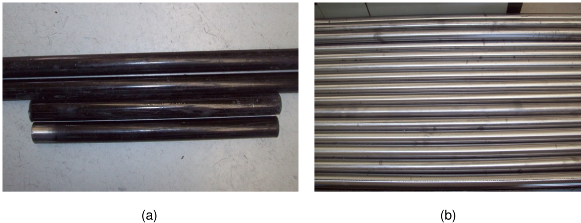
Fig. 2.3. Tubería de acero al carbono (a) antes y (b) después de la limpieza.
