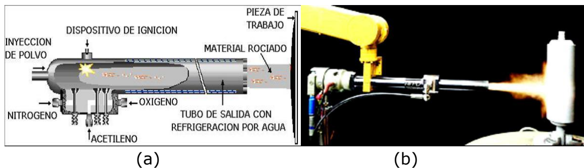
Figura 16. (a) Esquema de la antorcha (b) antorcha de aspersión del proceso D - Gun.
