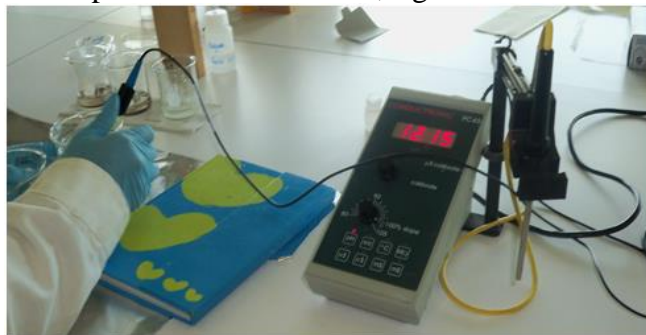
Figura 2.4. Medición de pH de la solución de CdS.
