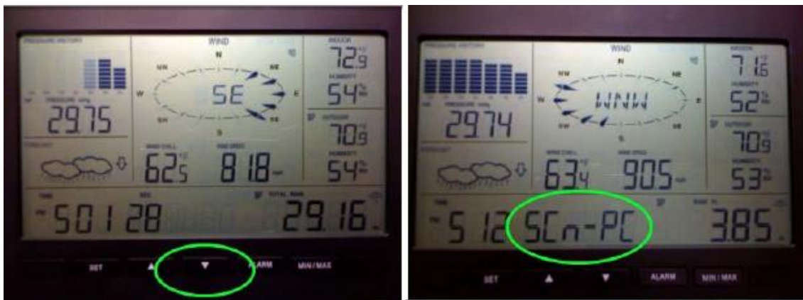
Figura 4.7 Sincronización del monitor con la computadora
