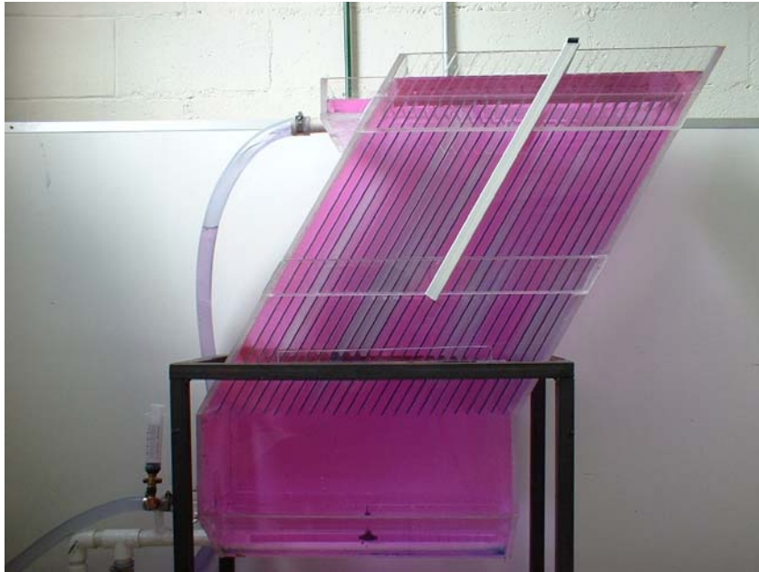
(a). Patrones de flujo utilizando colorante como trazador:
