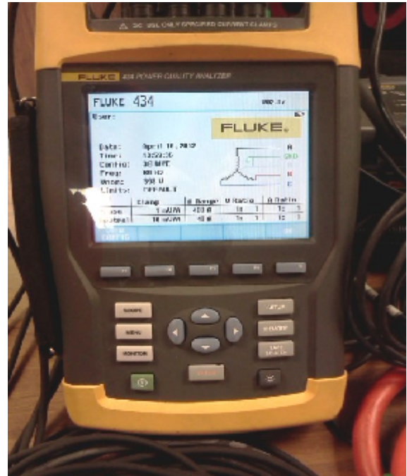
Imagen 1. Analizador de redes Fluke 434.
