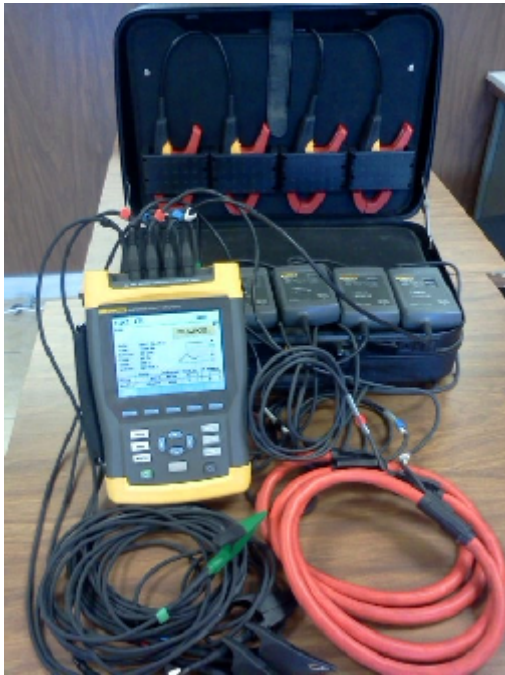
Imagen 1. Analizador de redes Fluke 434.
