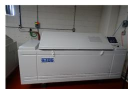
2. Exposición en cámara salina en base a la norma ASTM B117 con los siguientes parámetros:
