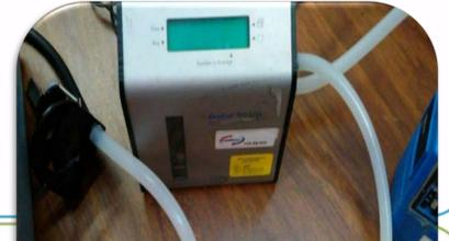
2. Se colocan los filtros en los porta filtros y estos en mini ciclones para separar las partículas. Posteriormente se conecta el sistema a una bomba, el sistema se calibra a un flujo de 2.5 l/min. Los filtros se colocan en el ciclón y la bomba comenzando así la toma de muestra.
