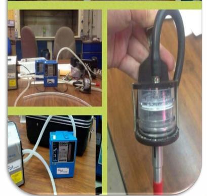
3. Con la muestra ya capturada se vuelven a acondicionar los filtros como al inicio para ser pesados y determinar la masa colectada y la concentración.
