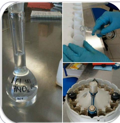
4. Digestión: esta consiste en extraer la mayor cantidad de los analitos, tratando de suprimir diferentes compuestos que pueden estar presentes en la muestra. Para este proceso se elaboró una solución compuesta por 18%v de ácido clorhídrico (HCl) y ácido nítrico (HNO<sub>3</sub>) un 6%v.
