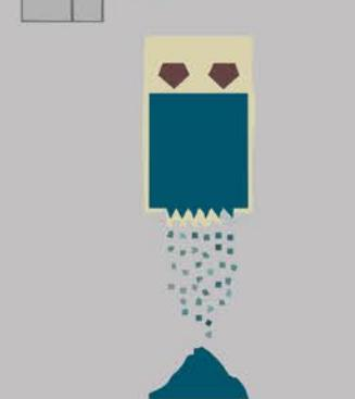
Se corta en trozos pequeños y se depositan en el molino para obtener un material granulado
