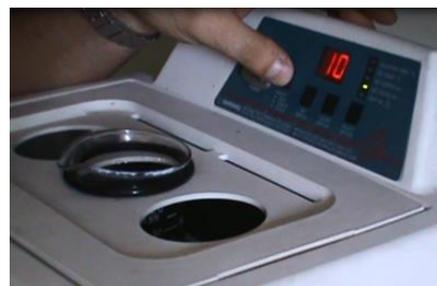
Ilustración 47 - Limpieza de los sustratos de  $Al_2O_3$
