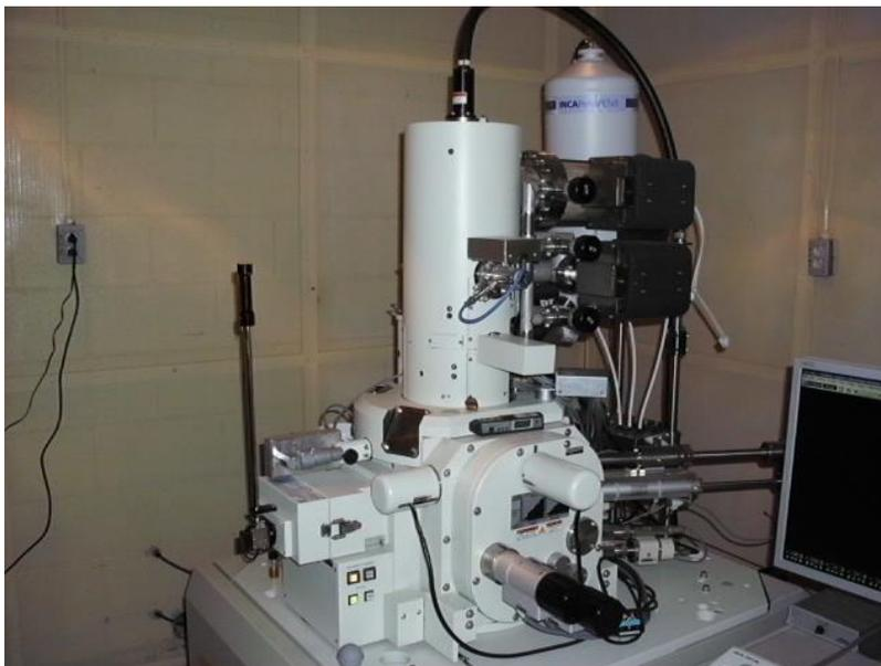
*Ilustración 60 - Microscopio Electrónico de Barrido de Emisión de Campo Modelo Nova Nano SEM 200 Marca FEI*
