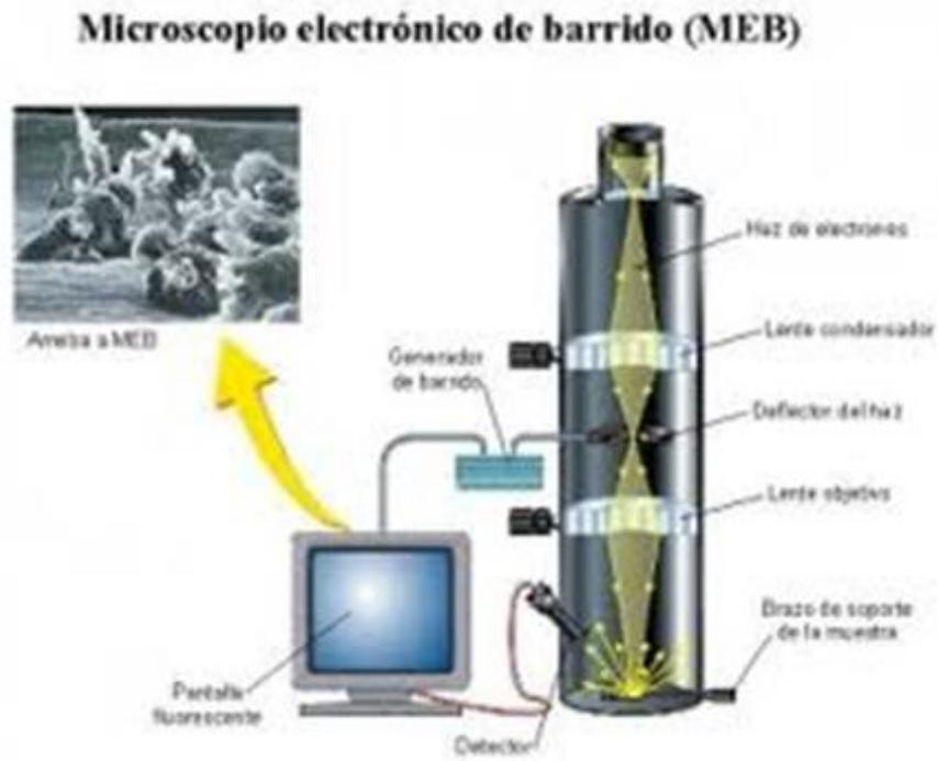
*Ilustración 35 - Partes del Microscopio electrónico de barrido*
