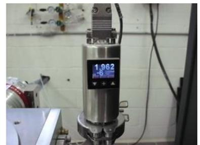
*Ilustración 54 - De izquierda a derecha: Colocación dl plato porta muestras en la pre-cámara. Colocación de tapa de la pre-cámara para cierre hermético. Ajuste de la presión de la pre-cámara a  $1.962 \times 10^{-6}$  torr*
