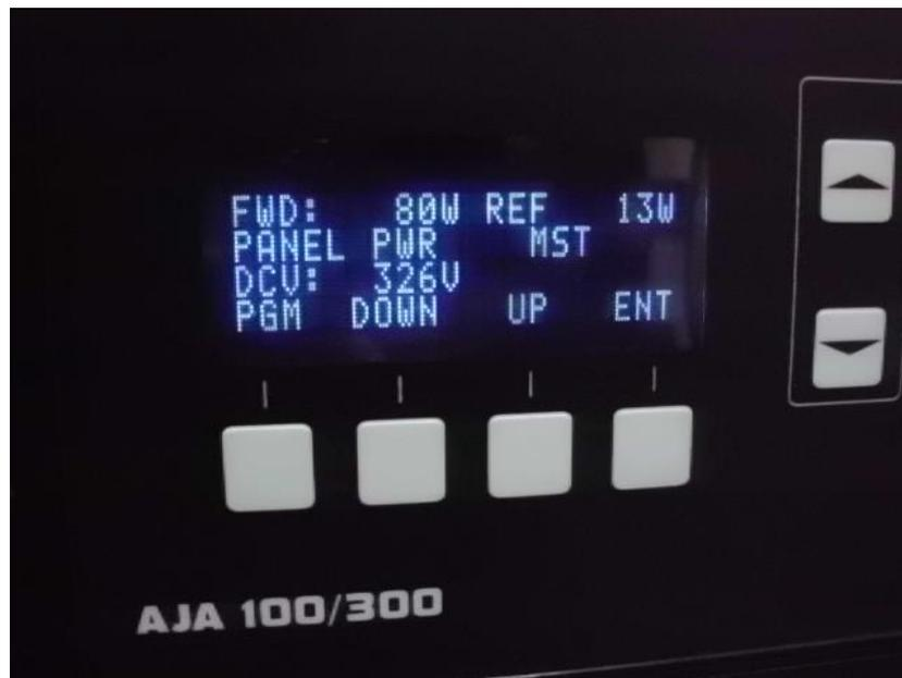
*Ilustración 52 - Panel de calibración del generador de radiofrecuencia y potencia de Equipo de Sputtering marca AJA International Inc. Mod. Orion 5 UHV*
