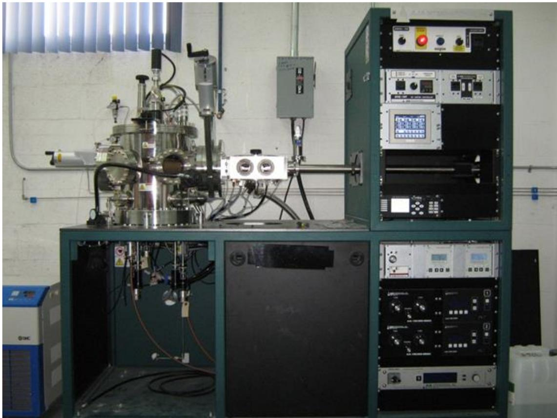
*Ilustración 49 - Equipo de Sputtering marca AJA International Inc. Mod. Orion 5 UHV.*
