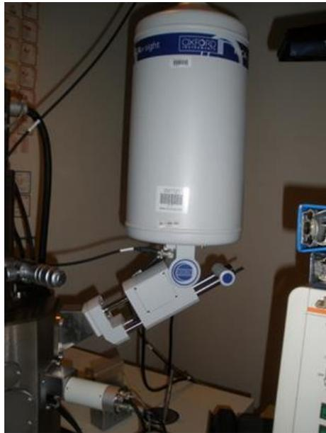
*Ilustración 36 - Equipo de Análisis Elemental por Energía Dispersa. El Nova NanoSEM200 está acoplado con un Sistema de Microanálisis Marca Oxford Modelo INCA X-Sight [28].*
