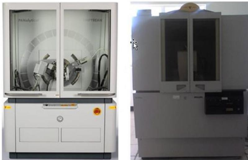
*Ilustración 40 - Equipos de difracción de rayos X. Izquierda: Panalytical Empyrean Derecha: Philips X'Pert MPD*
