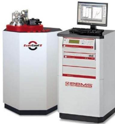
*Ilustración 42 - Sistema de Medición de Propiedades Físicas PPMS®*
