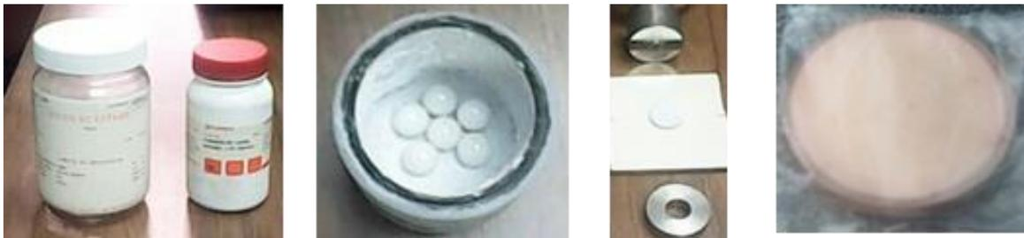
*Ilustración 43 - Proceso de preparación del target. De izquierda a derecha: Mezcla, molienda, prensado y sinterizado.*
