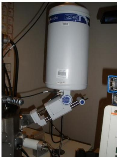
*Ilustración 48 - El Nova NanoSEM200 está acoplado con un Sistema de Microanálisis Marca Oxford Modelo INCA X-Sight.*
