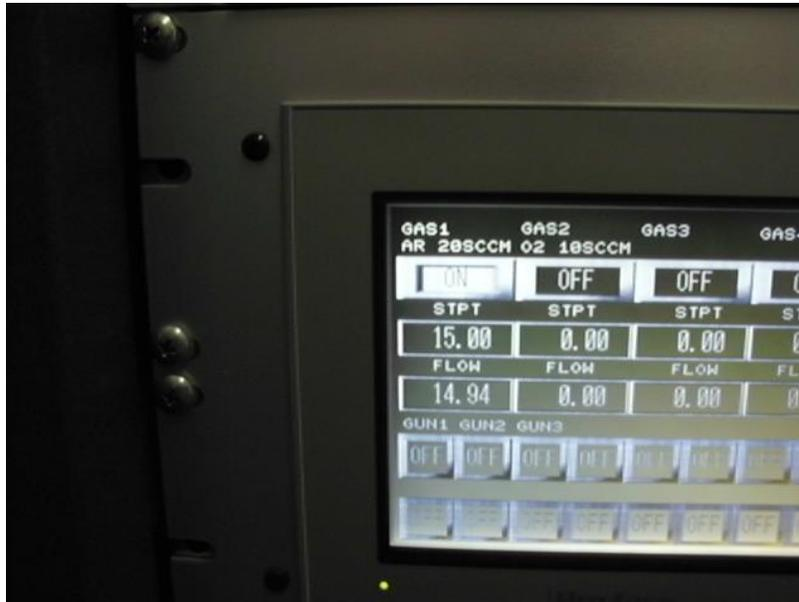
Ilustración 57 - Panel de control para el suministro de gas Argón
