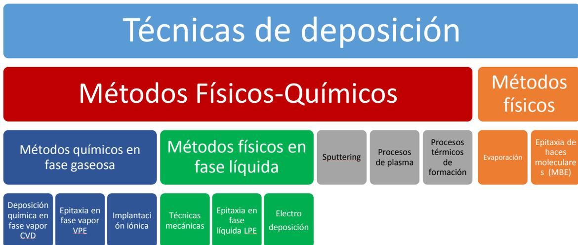
Ilustración 30 - Clasificación de técnicas de deposición
