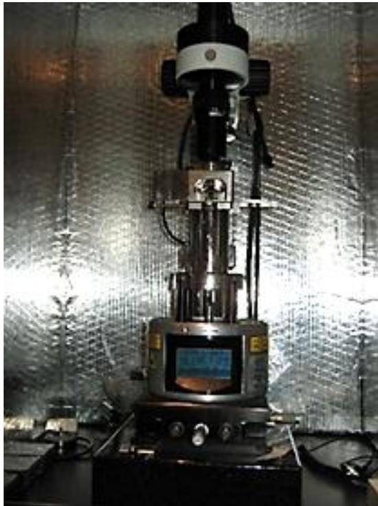
*Ilustración 38 - Microscopio de Fuerza Atómica Veeco SPM Multimode - CIMAV*
