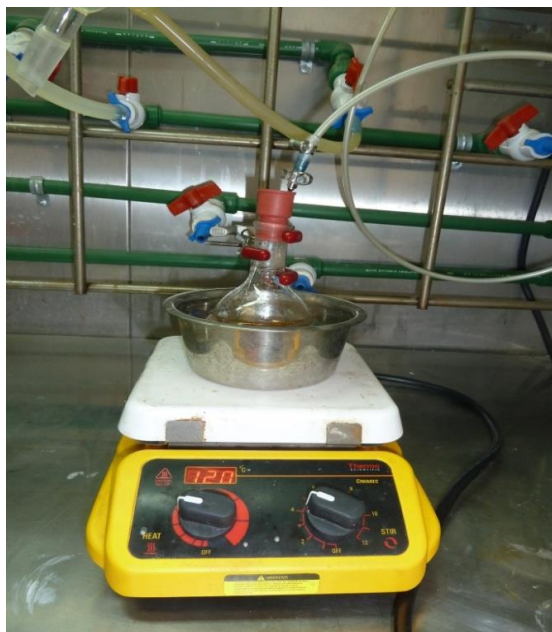
Figura 3.2 Polimerización vía RAFT con ácido Acrílico.
