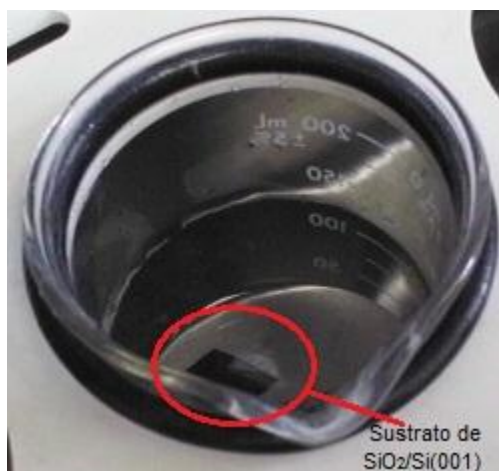
Figura 10 Sustrato de SiO_2/Si(001) en etanol en baño de ultrasonido.
