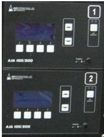
Figura 37 Suministro de energía a través de Radio Frecuencia. 2 suministro de energía por medio de Corriente Directa.
