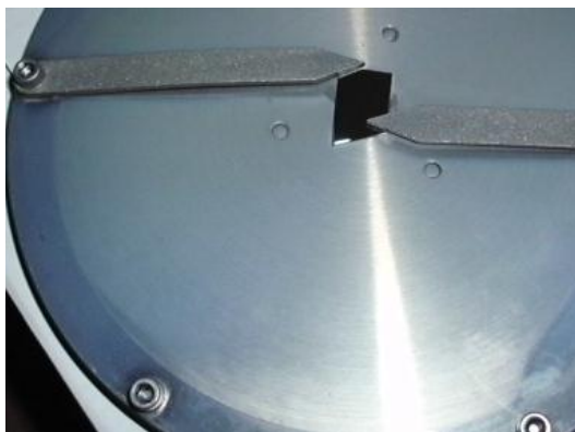
Figura 12 Sustrato de \text{SiO}_2/\text{Si}(001) colocado e inmobilizado en el porta-muestras del equipo sputtering.
