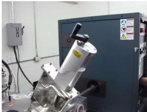
Figura 24 El ajustador de la válvula que separa la cámara de crecimiento de la pre-cámara
