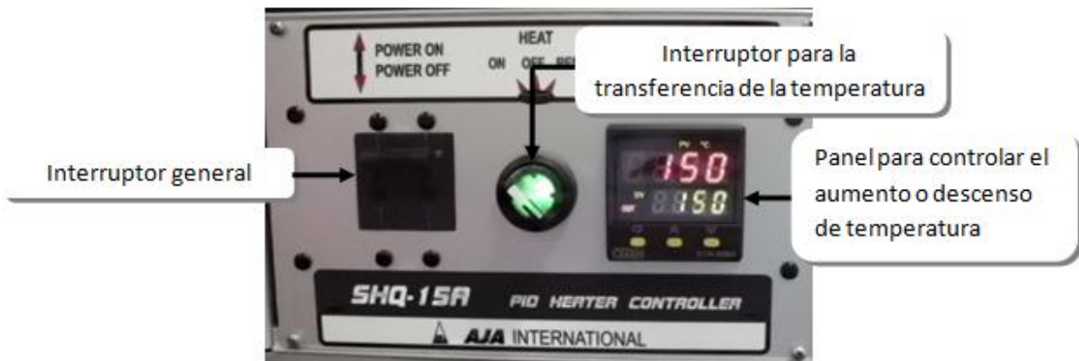
Figura 33 Control para la transferencia de temperatura.
