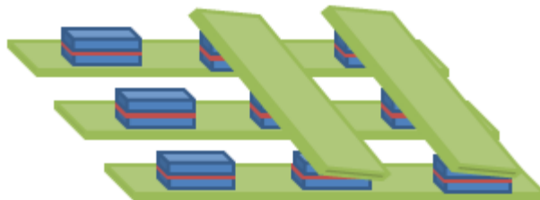
Figura 4 Representación esquemática de la arquitectura de la MRAM, en cada intersección de las líneas se tienen un UTM.
