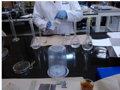
Figura 6.15 Preparación de una película por medio de depósito químico en UNAM
