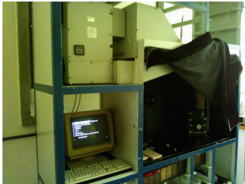
Figura 6.13 Cámara de simulación del espectro del Sol Unam.
