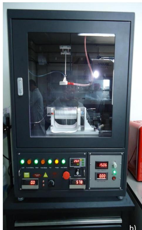
**Figura 5.** a) Formación del Cono de Taylor y b) Equipo de Electrohilado en CIMAV-Chihuahua, respectivamente. (Se puede apreciar un cable conectado a la aguja, suministrando una tensión de 15000 volts y se observa una pantalla colectora cilíndrica rotando a 578 r.p.m.).
