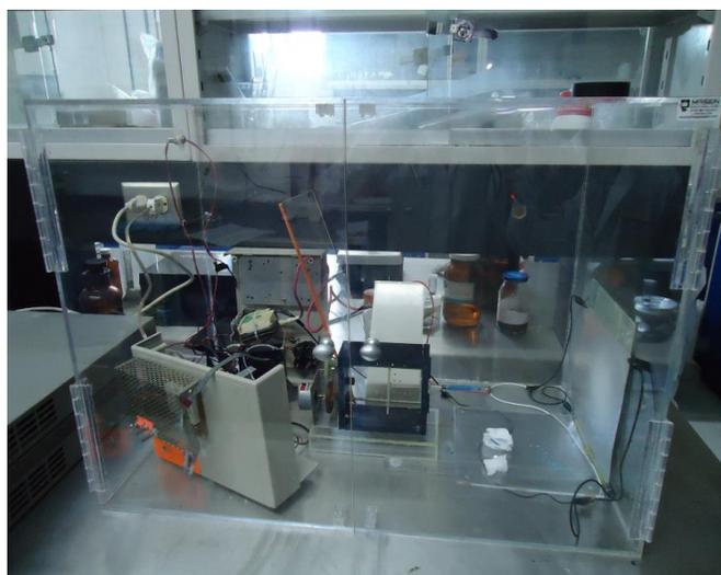
**Figura 6.** Equipo de Electrohilado con pantalla colectora estática (CIMAV- Chihuahua) (D. Carrillo., 2013)
