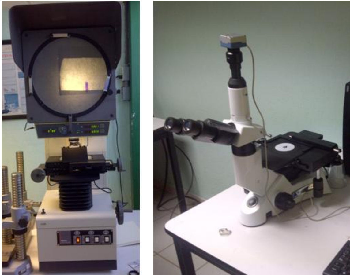
Fig. 19 Proyector de perfiles Mitutoyo PJ3000 y Microscopio PTS modelo PTIS NM.
