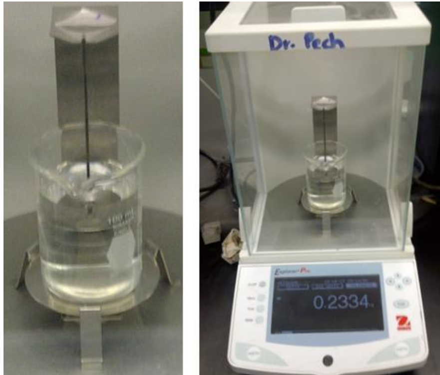
Fig. 14 Medidor de densidad y balanza analítica con el medidor de densidad en el interior.
