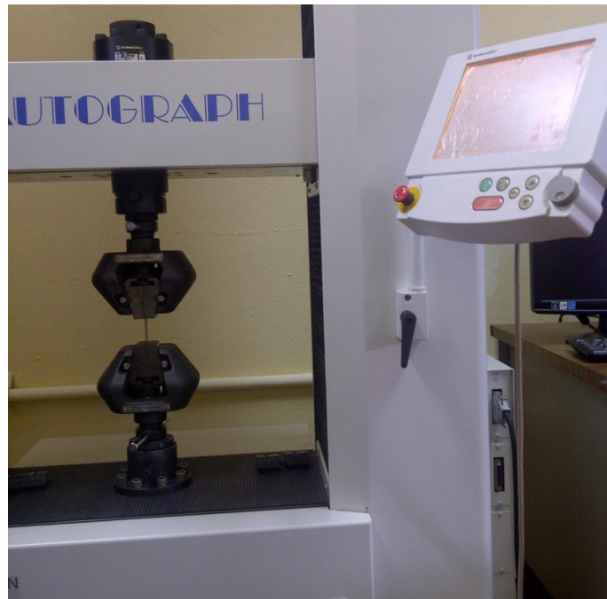
Fig. 16 Máquina universal modelo AG-I marca Shimadzu.
