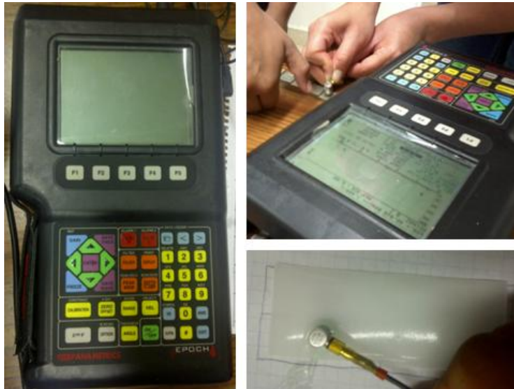
Fig. 15 Detector de flujo ultrasónico, calibración y toma de lecturas.
