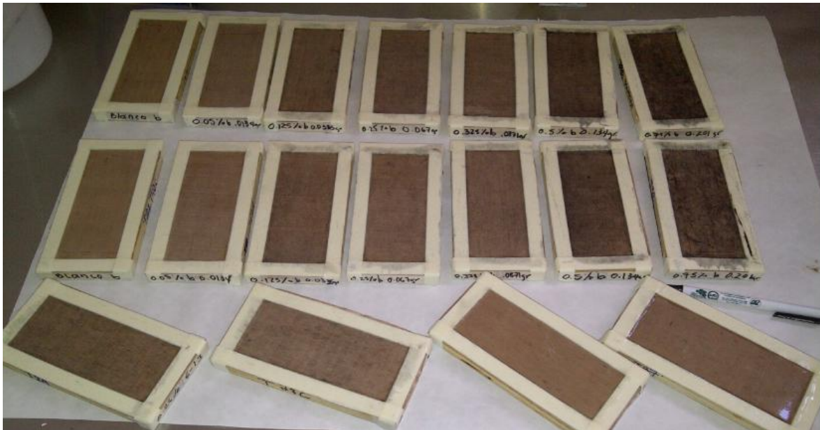
Fig. 12 Curando el poliuretano reforzado con fibra de carbono reciclado.
